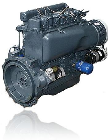
**1. Силовой агрегат Д144** - рядный четырехцилиндровый дизельный двигатель с вертикальным расположением цилиндров. Одна из главных особенностей мотора — воздушное охлаждение, благодаря чему удалось значительно снизить массу и упростить конструкцию агрегата (воздушное охлаждение делает ненужной водяную рубашку в блоке цилиндров и в ГБЦ, водяной насос, систему трубопроводов и датчики, что и делает мотор значительно легче и проще).
