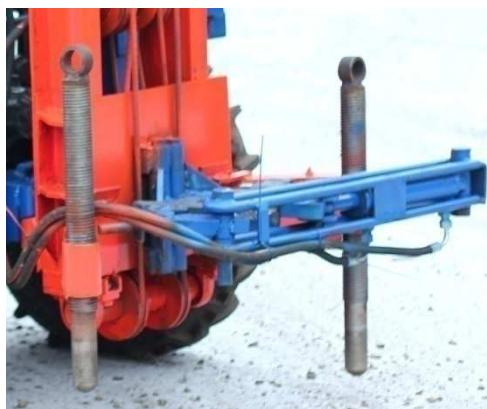
**4. Выставляется в рабочее положение УДВ** за счет четырех винтовых упоров, что позволяет максимально задействовать вес буровой установки при бурении.
