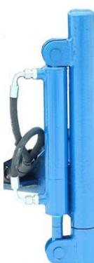
6. Для тех кто ценит своё время и хочет максимально быстро приступить к работе, а также при бурении неглубоких скважин (под сваи или столбы) компания ТИЗАР устанавливает на буровые установки гидравлические аутригеры, которые позволяют в кратчайшее время и с минимальными усилиями выставить буровой станок.
