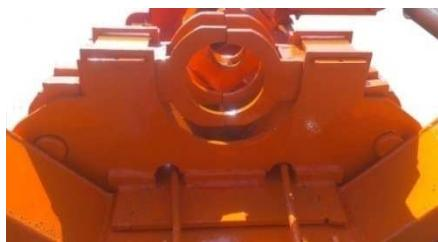
Конструкция трубы-зажима позволяет работать максимальным диаметром бурового инструмента 215 мм. также в комплект входят съемные кулачки для зажима бурового инструмента диаметром 60,3 мм., для обсадной трубы диаметром 160, 125 если необходимы кулачки под другие диаметры необходимо согласовать их размеры при составлении спецификации к буровой установке.
