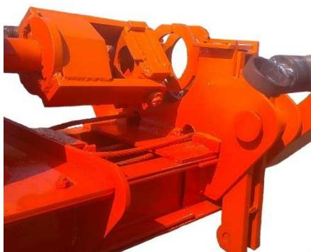
**3. Труба-зажим гидравлический** - позволяет осуществлять фиксацию буровой колоны при спускоподъёмных операциях, а также при необходимости может использоваться при обсадке скважин обсадной трубой, производить задавливание и вытягивание с усилием 4 т.
