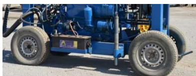
**7. Колёса R13.** В базовой комплектации на буровую установку с целью снижения её стоимости, устанавливаются стандартные колеса R13.
