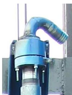
**8. Вертлюг промывочный** предназначен для подачи промывочной жидкости от насоса к забою скважины и обеспечения возможности вращения буровых труб при бурении. Вертлюг устанавливается с верху на шпиндель вращателя, который жестко фиксируется к корпусу вращателя. В процессе бурения по мере увеличения подтекания бурового раствора через дренажное отверстие, необходимо производить подтяжку сальниковой набивки, подтягивая поочередно четыре болта с низу.
