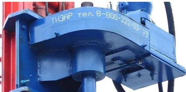
**3. Вращатель** - сухого типа, привод осуществляется за счет двухрядной цепной передачи. Вращатель состоит из:
