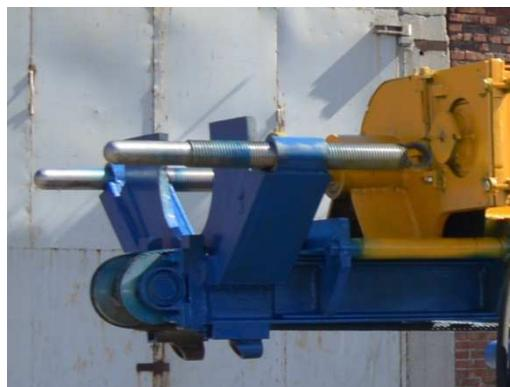
**5. Рабочий стол** изготавливается из листовой стали толщиной 20 мм. , проходной диаметр инструмента 220 мм. Для удерживания инструмента при спуско-подъёмных операциях используется подкладная вилка. Надежная и в тоже время простая конструкция рабочего стола, позволяет осуществлять бурение на большие глубины, без малейшего риска потери бурового инструмента.
