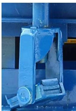
**4. Элеватор** представляет собой приспособление, предназначенное для соединения отдельной свечи или бурильной колонны с механизмом, который осуществляет подъём и спуск бурового инструмента.
