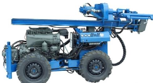
5. В базовой комплектации буровых установок УДВ-70 и УДВ-600 (4x4) устанавливаются стандартные колеса R13 с шинами общего назначения. Для увеличения проходимости буровых установок компания ТИЗАР предлагает установить колёса которые применяются на тракторах и сельскохозяйственных машинах. Шины R16 радиальной конструкции с рисунком протектора повышенной проходимости, который обеспечивает надёжную работу буровой установки в полевых условиях и хорошие самоочищение.
